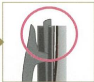
ワイパーゴムの裂け
